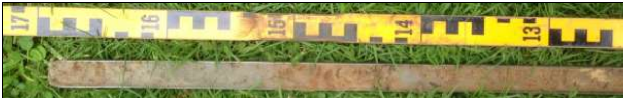
Figuur 23: Alluviale sedimenten van de Geul in boring 13 vanaf 1,2 m –mv
